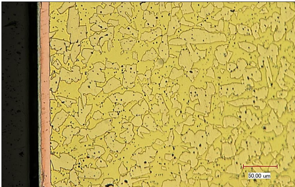
Bild 16: Metallographisches Schliffbild einer geschädigten Kehlnaht
