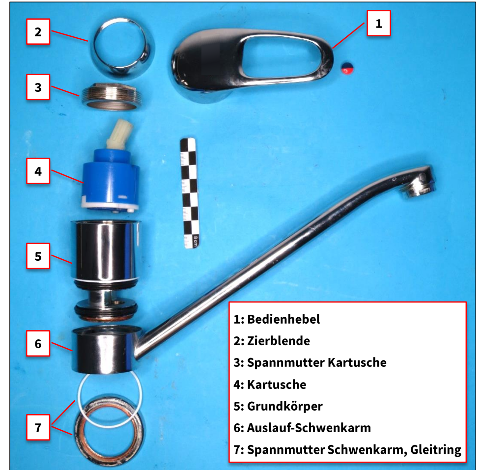
Bild 2: Explosionsdarstellung einer Vergleichsarmatur mit Bezeichnung der Einzelteile
