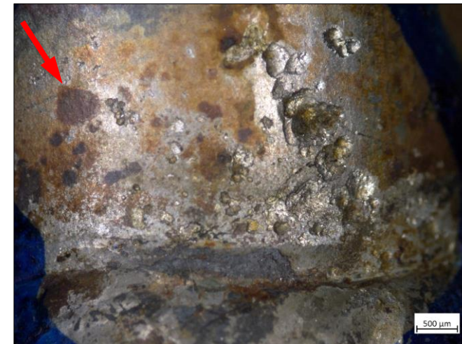
Bilder 6 und 7: Übersichts- und Detailaufnahme einer Leckagestelle, Pfeil kennzeichnet braune, filmartige Rückständen
