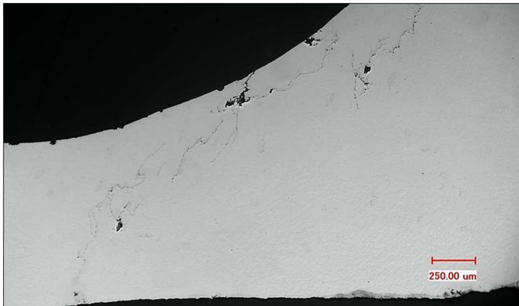
Bild 16: Metallographisches Schlibbild einer geschädigten Kehlnaht
