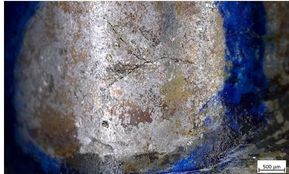
Bilder 8 und 9: Übersichts- und Detailaufnahme der Leckagestelle im Bereich einer Kehlnaht
