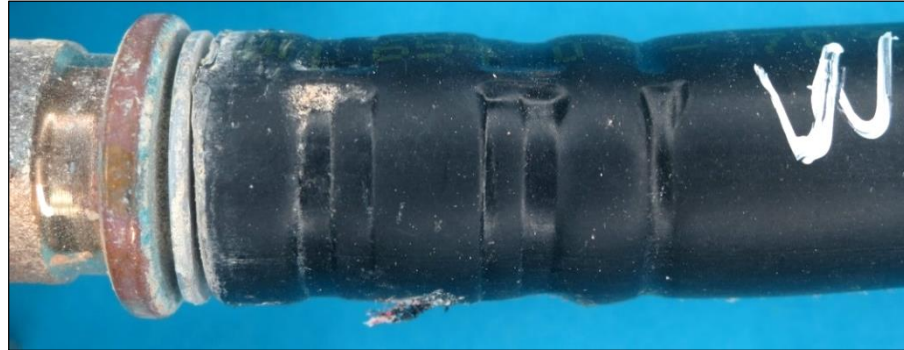
Bilder 2 und 3: Detailaufnahmen einer Pressstelle zur Wandscheibe
