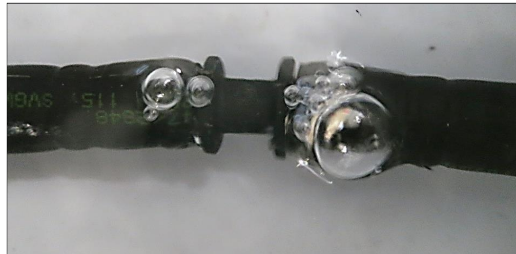
Bild 7: Beispielhafter Leckagebefund an Pos. 2.2 und 2.3
