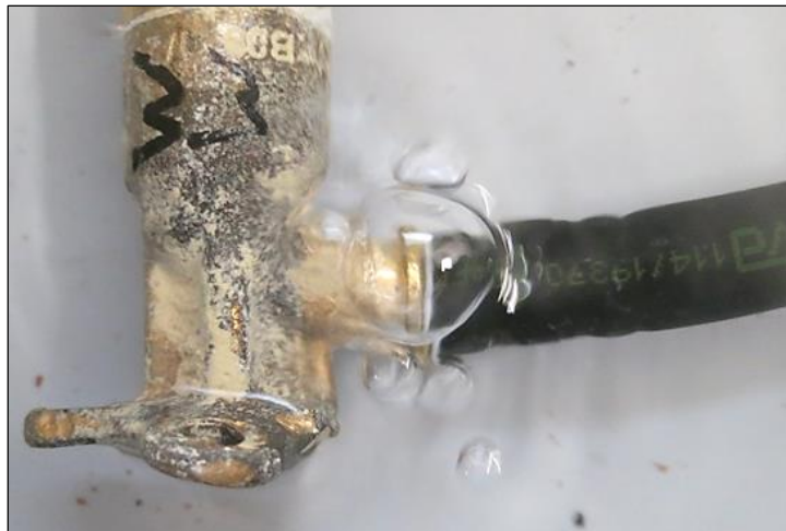
Bild 6: Beispielhafter Leckagebefund an Pos. 2.1
