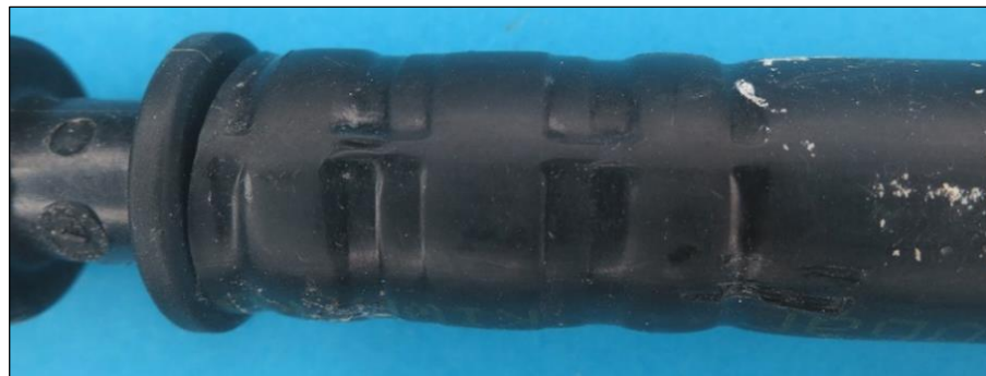
Bilder 4 und 5: Detailaufnahmen einer Pressstelle zur Systemkupplung
