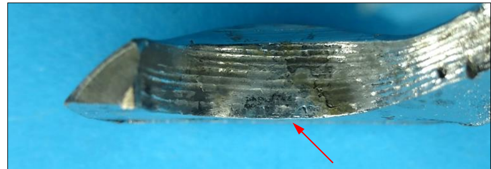
Bild 6: Detailaufnahme der Bolzendurchführung an Bruchstelle III in Richtung des Rührwerks (Lastflanke) mit Oberflächeneinebnung und Abrasionsspuren (Pfeil)
