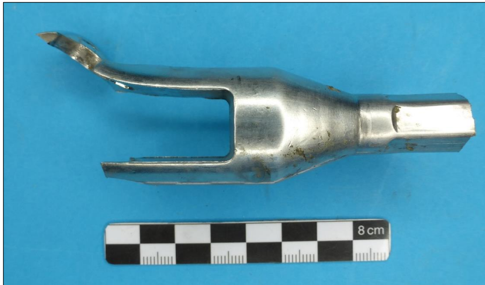
Bilder 1 und 2: Übersichtsaufnahmen des untersuchungsgegenständlichen Gabelkopfes
