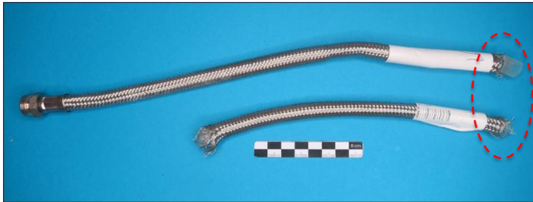
Bild 1: Übersichtsaufnahme des untersuchungsgegenständlichen Schlauches mit Kennzeichnung der Schadensstelle
